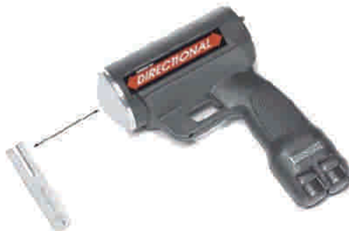
Figura 6.4 Coloque el diapasón vibrador aproximadamente 3 pulgadas frente a la antena.
