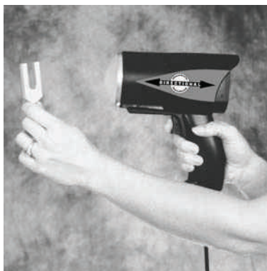
Figura 6.3 Coloque el diapasón vibrador aproximadamente 3 pulgadas frente a la antena.
